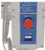
緊急停止ボタン
